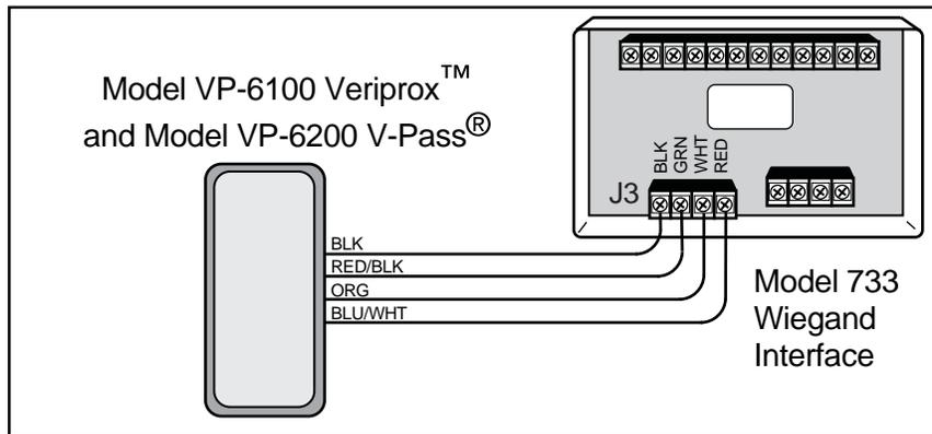
Figure 3: 733 wiring
