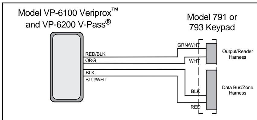
Figure 4: Keypad wiring
