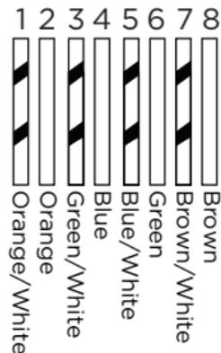
**Figure 15: Cat 5 568-B Wiring**
