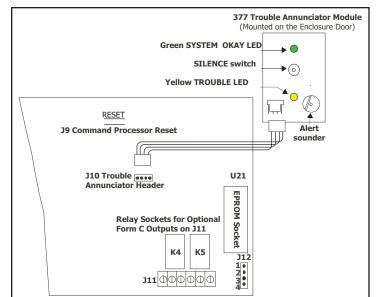
Figure 4: 377 Module Wiring
