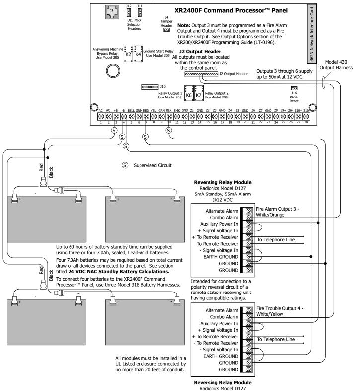
5mA Standby, 55mA Alarm @12 VDC
